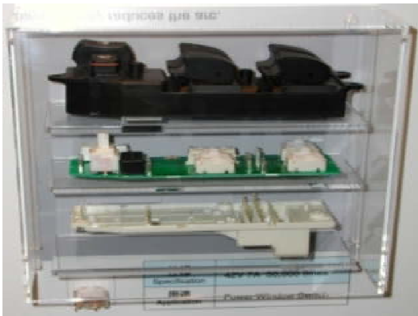
【図】アーク対策を施した直切り方式のパワーウィンドウ用スイッチ。定格の電流値が7A，耐久回数は5万回
