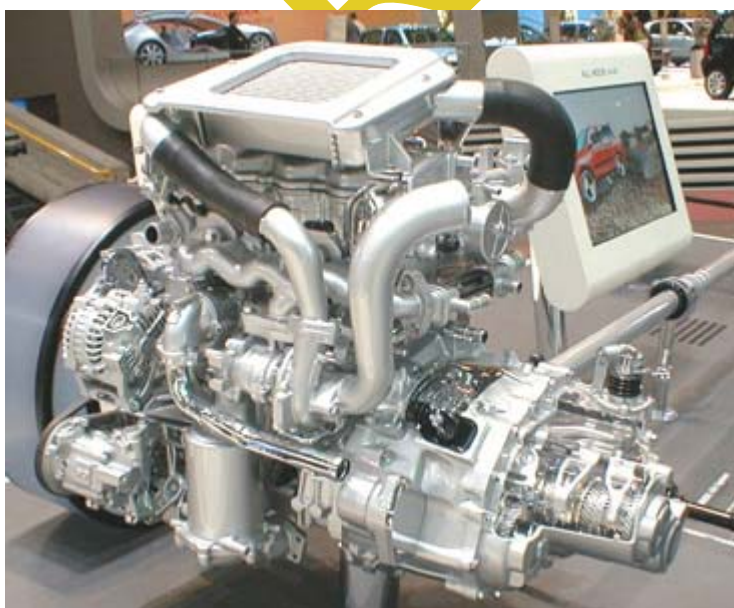
[ 図 5 ] 日産自動車「エクストレイル」の欧州仕様車に搭載されている排気量 2.2L の直噴ターボディーゼルエンジン「YD 22DDTi」。第二世代の「M-Fire」燃焼を取り入れている
