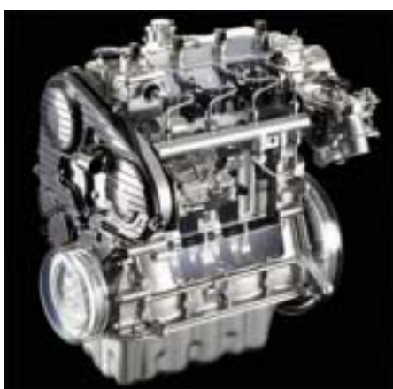
[図 4]アテンザの欧州仕様車に搭載される新開発の直噴ディーゼルターボエンジン
