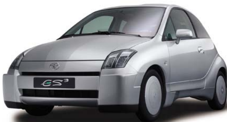
[ 図 6 ] トヨタ自動車のコンセプトカー「ES3」。ディーゼルエンジンと CVT を組み合わせて 47km/L という低燃費を実現したうえ，ガソリン車の「優-低排出ガス」レベルの排ガスクリーン化を実現した
