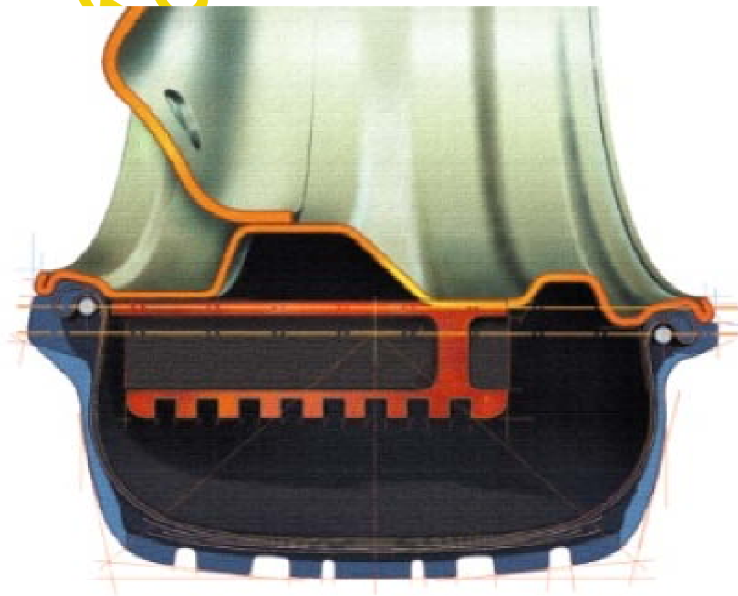
【図 1】サイド補強式のランフラットタイヤの構造
